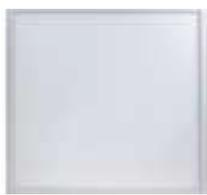
Gruppo di alimentazione, per una potenza complessiva di 40W 4000°K IRC >80, di tipo elettronico (cos j >0,9) 230V~50Hz, flusso >4000 lm.. Il fissaggio a soffitto/parete sarà previsto con delle staffe di bloccaggio a cornice facilmente sganciabili in caso di manutenzione. Il corpo illuminante deve risultare conforme alle prescrizioni CEI EN 60598-1, EN 60598-2-1, UNI9554:1989 ed EN 62471 (Rischio fotobiologico).
