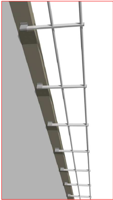
ESEMPIO DI PARAPETTO
