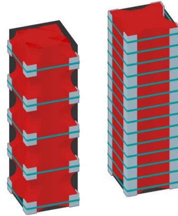
**Disposizione del rinforzo a cerchiaggio di un pilastro**
