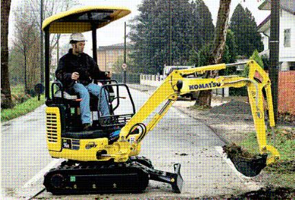
Macchina di piccole dimensioni, di ridotte capacità di scavo ma molto efficiente per lavorare in spazi ristretti. Ha particolarità costruttive uniche, come ad esempio il Bobcat che è una pala caricatrice, priva di ruote sterzanti. La sua manovrabilità avviene frenando le ruote in gomma come nei mezzi cingolati.
