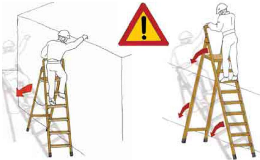
· Erroneo uso della scala: posizione laterale e sistema di accesso ad altro luogo
