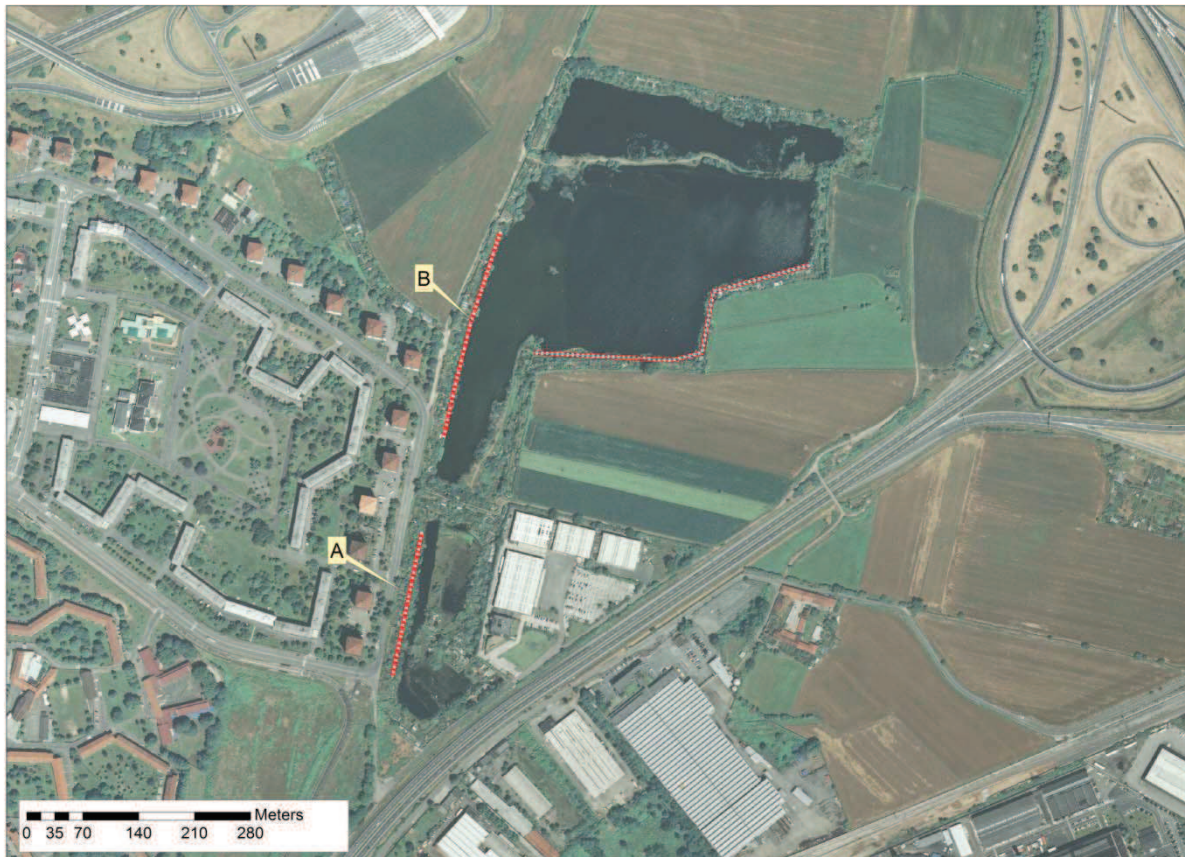
Figura 7 - Settori spondali maggiormente acclivi, con evidenze di instabilità morfologiche (tratteggio in colore rosso). Con le lettere A, B sono indicati i dissesti localizzati di cui alla figura Figura 6 a,b.
