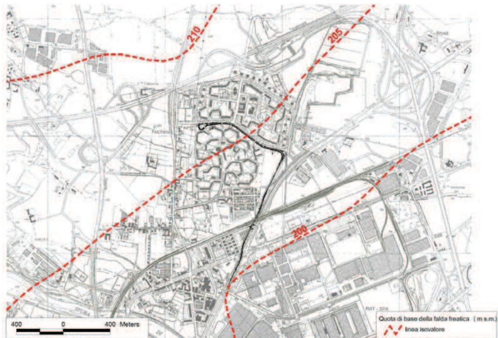
Figura 4 - Profondità della base della sequenza ghiaioso sabbiosa costituente l'acquifero freatico (da tematismi informatizzati del Progetto PRISMAS – Università di Torino, Dipartimento di Scienze della Terra).
