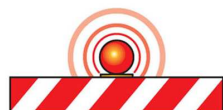
Barriera normale, sormontata da un dispositivo luminoso a luce rossa a delimitazione zona lavori.
