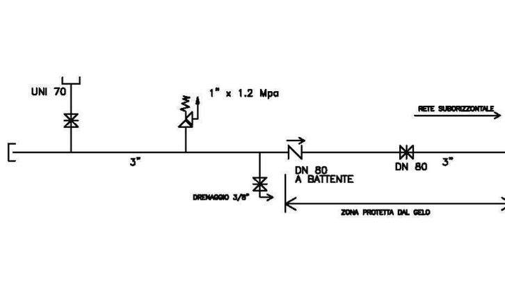
Schema idraulico di collegamento componenti stazione pompe antincendio
