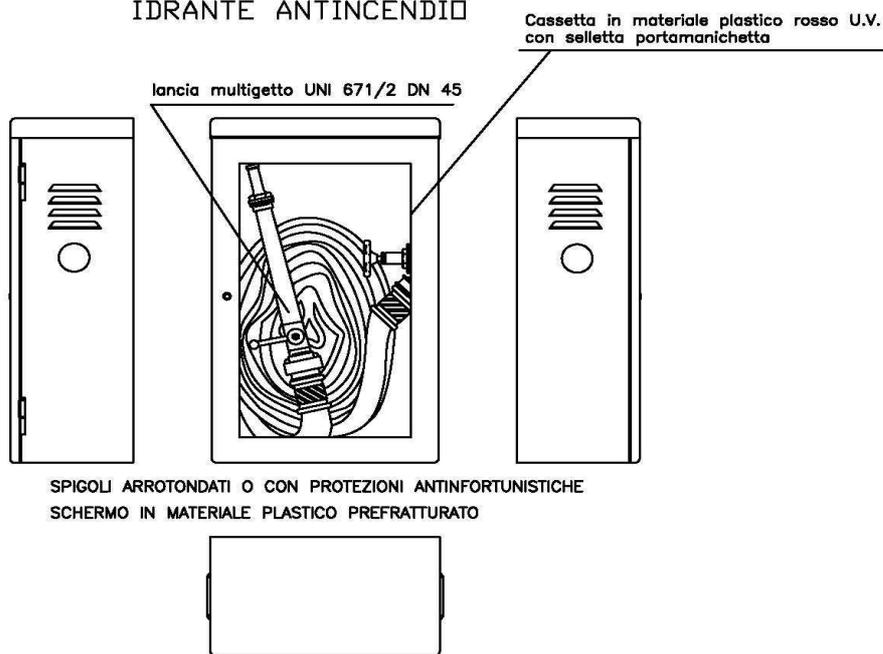
PARTICOLARE SCHEMATICO IDRANTE SOPRASSUOLO
