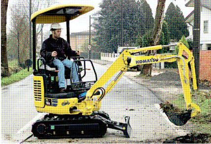
Macchina di piccole dimensioni, di ridotte capacità di scavo ma molto efficiente per lavorare in spazi ristretti. Ha particolarità costruttive uniche, come ad esempio il Bobcat che é una pala caricatrice, priva di ruote sterzanti. La sua manovrabilità avviene frenando le ruote in gomma come nei mezzi cingolati.
