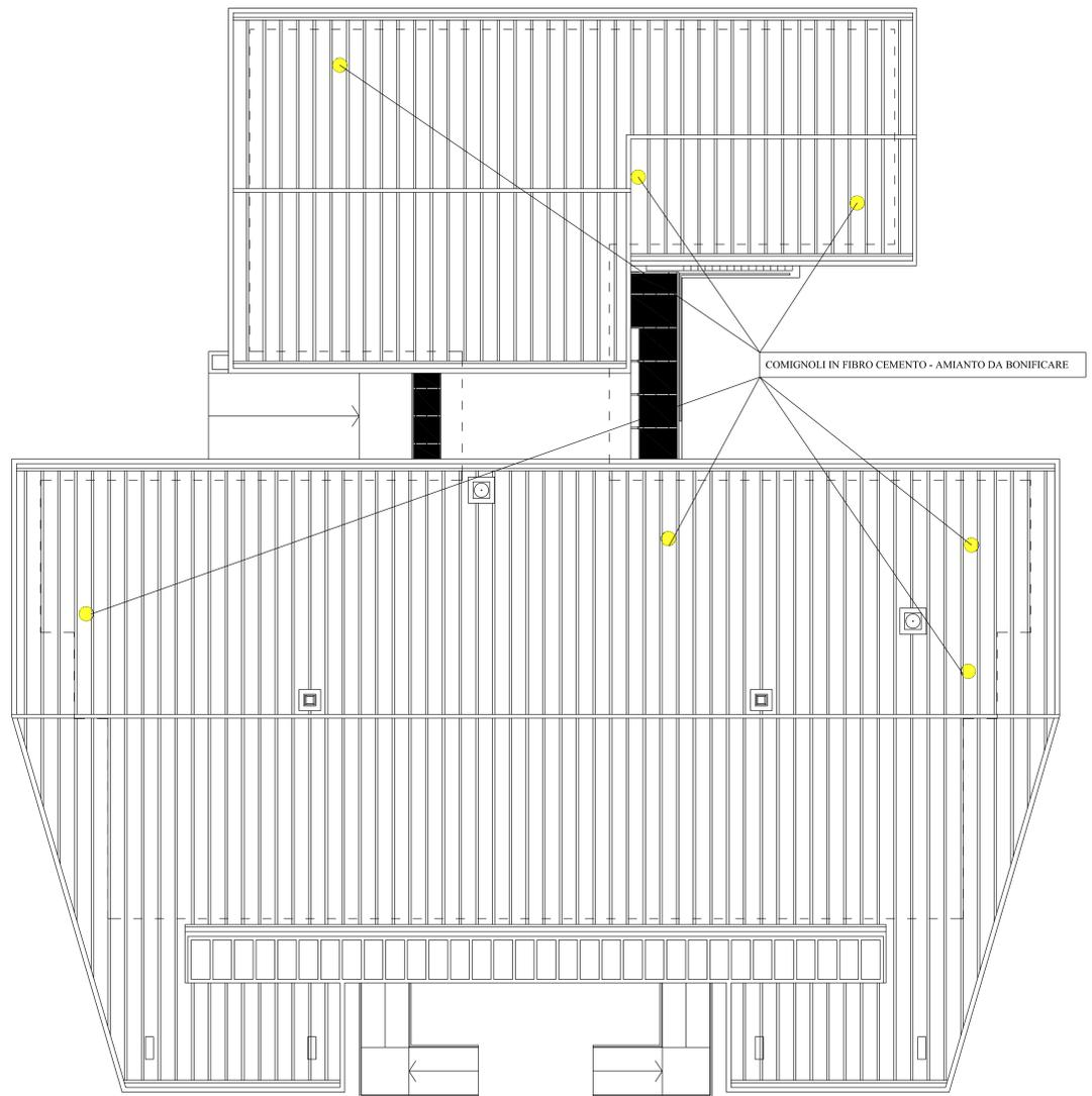
PIANTA COPERTURA - PROGETTO - scala 1:100
