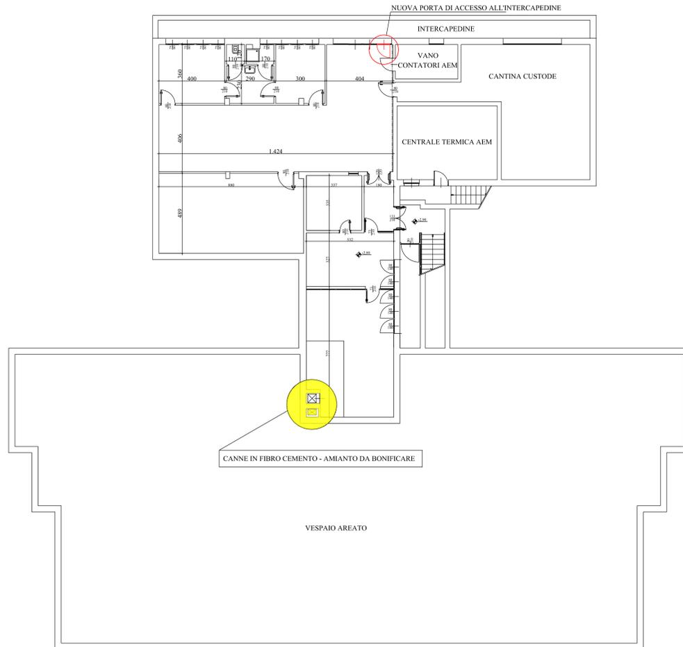
PIANTA PIANO INTERRATO - PROGETTO - scala 1:100
