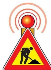
**Cartello lavori**, da installare in prossimità del cantiere quando il tratto di strada interessato sia più lungo di 100 m sormontato da dispositivo luminoso a luce rossa.
