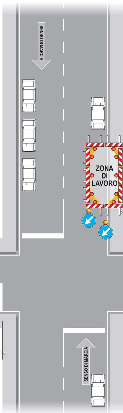
**Barriera normale**, sormontata da un dispositivo luminoso a luce rossa a delimitazione zona lavori, se il cantiere rimane aperto durante le ore notturne o in condizioni di scarsa visibilità.
