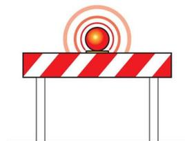
**Dispositivo luminoso** a luce gialla lampeggiante installato sui cartelli di passaggio obbligatorio, e da impiegarsi se il cantiere rimane aperto anche nelle ore notturne o in condizioni di scarsa visibilità.
