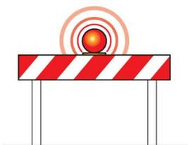
**Cartello lavori**, da installare in prossimità del cantiere quando il tratto di strada interessato sia più lungo di 100 metri e sormontato da dispositivo luminoso a luce rossa.
