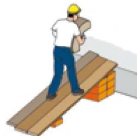
Il pavimento o il punto di appoggio sono instabili
