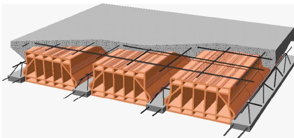
**Figura 22.2 - Esempio di solaio in cemento armato a travetti tralicciati e blocchi interposti<sup>4</sup>**
