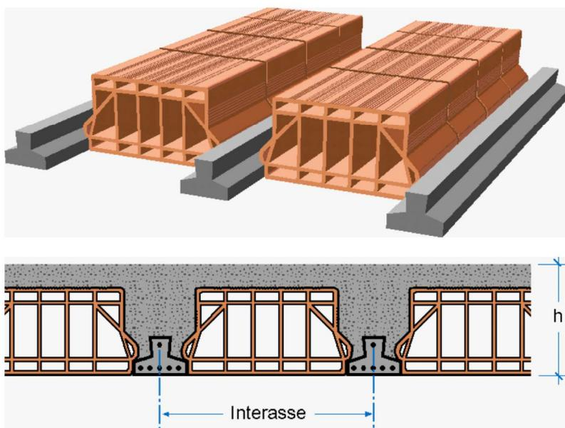
**Figura 22.3 - Esempio di solaio in cemento armato a travetti in cemento armato e blocchi interposti<sup>5</sup>**
