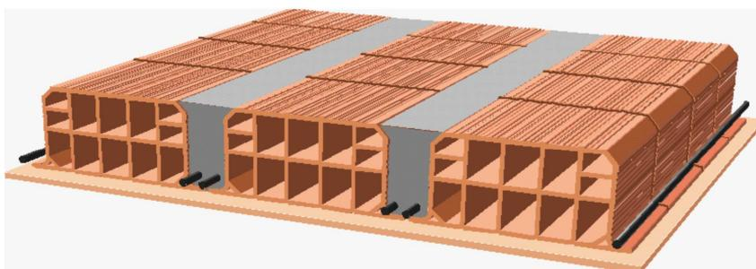
**Figura 22.1 - Esempio di solaio in cemento armato gettato in opera<sup>3</sup>**
