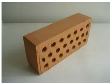
Figura 19.2 - Esempio di mattone semipieno 15\% < \square \leq 45\% in laterizio per murature portanti 2
